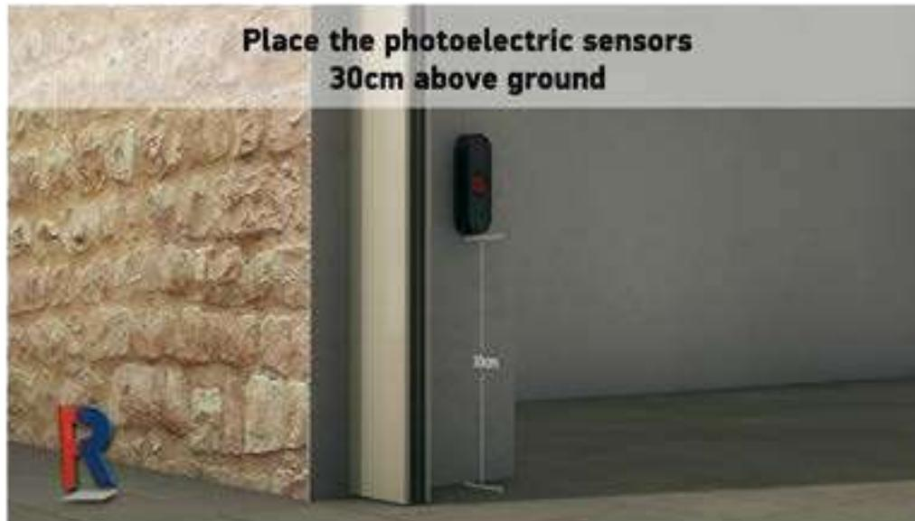
Legen Sie die photoelektrischen Sensoren 30 cm über dem Boden, einander zugewandt.
